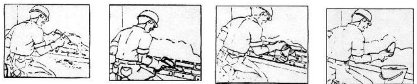
A) Picar el revoque existente B) Realizar dos hileras de perforaciones. Según las indicaciones. C) Introducir embudos en los orificios y colocar Inertol® Infiltración dejando que penetre el consumo indicado para cada tipo de pared. D) Finalizar los trabajos de acuerdo a lo indicado.
